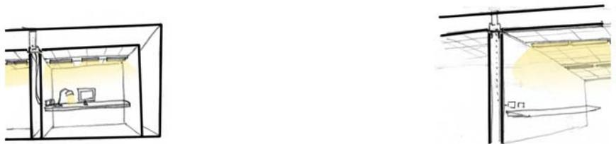
Ejemplo constructivo de descenso de la ICC desde el falso techo hasta el plano del usuario, mediante su trazado a través de mamparas ligeras
